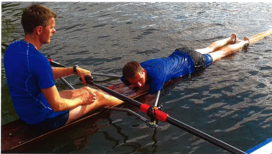
Rettung eines Gekenterten: Der Ruderer legt sich mit dem Oberkörper über das Boot. Selbst ein Renneiner trägt dank des hinteren Luftkastens die Last.
